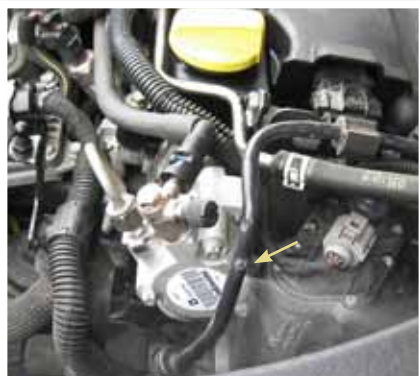
Nach 27.600 Kilometern mit dem Kraftstoff E10 trat im Betrieb bei etwa 120 bar ein feiner Kraftstoffstrahl am Pumpengehäuse aus – das Fahrzeug war vom Hersteller nicht für E10 freigegeben.
