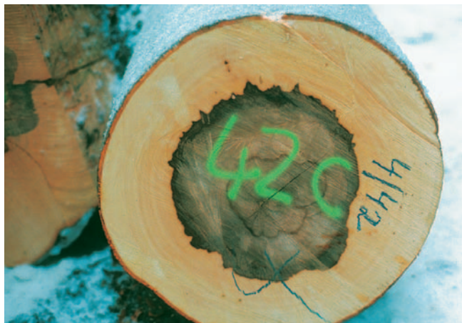
> Auf den Stammenden können Länge, Durchmesser, Qualität und weitere Informationen vermerkt werden.
