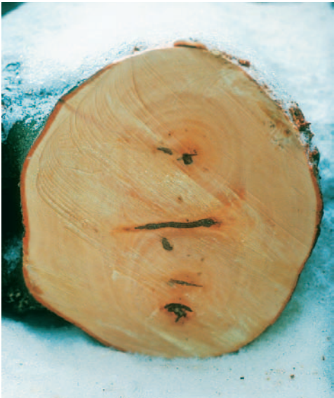
> Trennschnitt zu nahe am Zwiesel!
