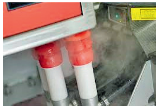
Foto 20: Zwischendesinfektionsanlage mit Heißdampf.
