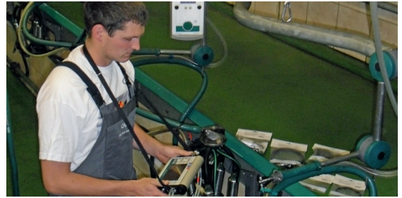
Foto 6: Pulsatorprüfung von geschulten Technikern durchführen lassen.
