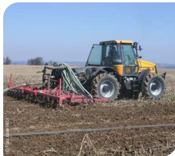
Abb. 26: Auch Geflügelmist ist auf Flächen ohne Bodenbedeckung unmittelbar, jedoch innerhalb von vier Stunden einzuarbeiten.
