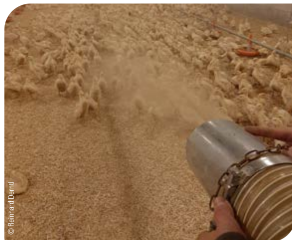
Abb. 129: Halb automatisches Einstreuen mit Strohmatic Air
